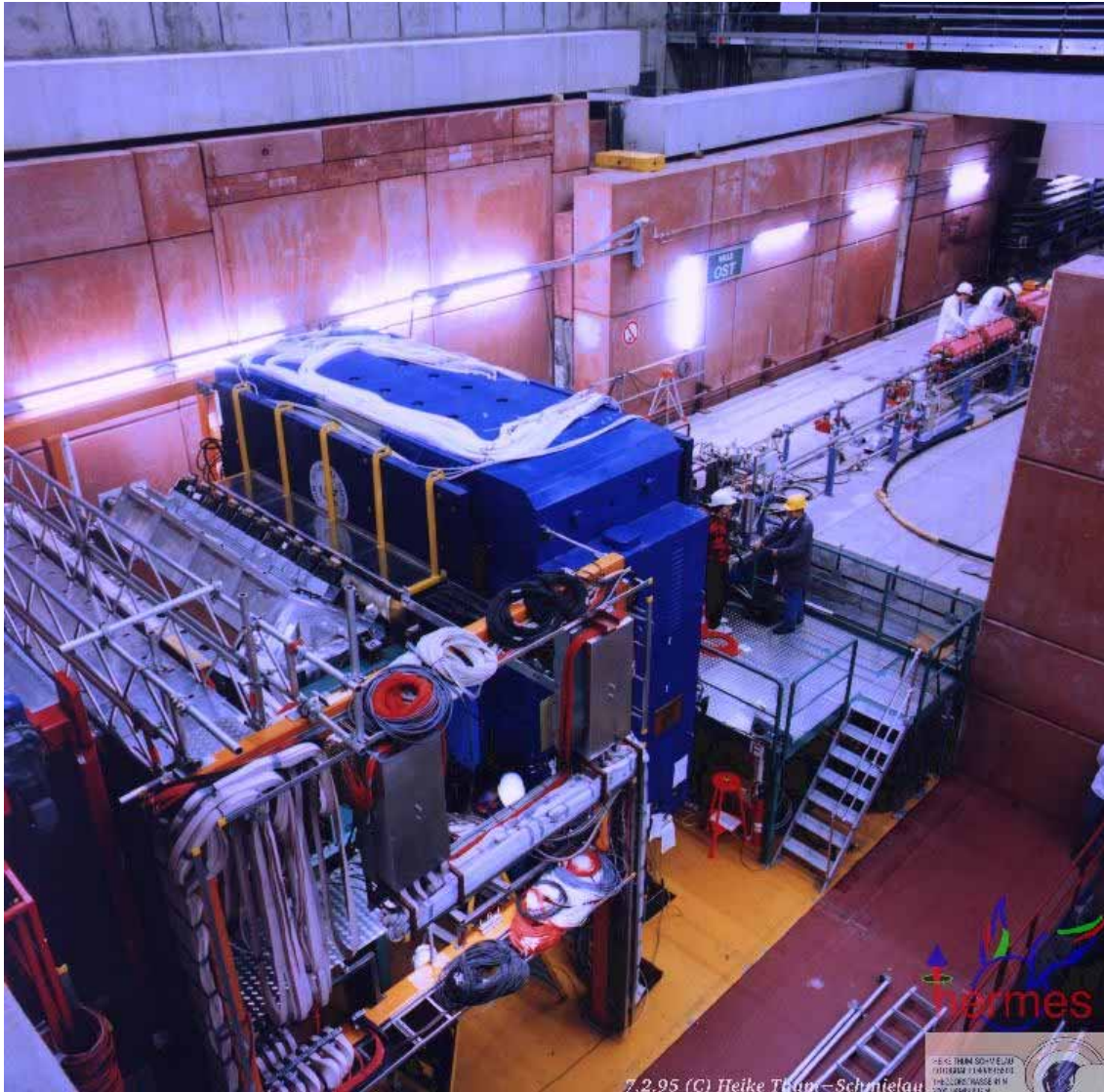
Fig. 4. Fotografia dello spettrometro HERMES installato sull'anello di accumulazione HERA. In alto a destra è visibile il tubo a vuoto all'interno del quale circola il fascio di elettroni polarizzati. Al centro sono visibili il bersaglio polarizzato e il dipolo magnetico (azzurro). A valle del dipolo sono visibili alcuni rivelatori di tracciamento e di identificazione delle particelle
